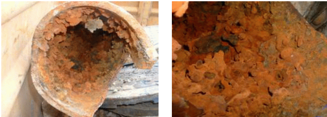
图 3 腐蚀后的 DN400 铸铁管管垢特征
