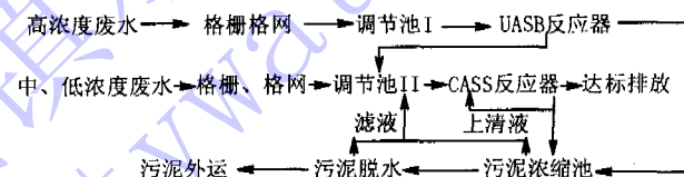
图1 污水处理工艺流程
